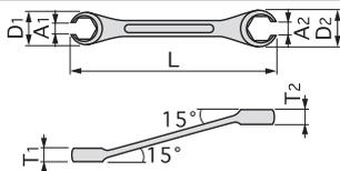
配管用のレンチです。ブレーキパイプや高圧パイプ用ナットの作業に最適です。角度は力を加えやすい15°設計。
