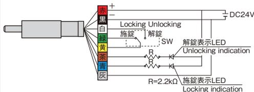
スイッチの接点定格は、DC24・10mA以上のものを使用して下さい。
