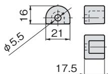
■パネル面表側からの取付け時のパネル穴明け(ねじ止め用)
