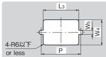
■パネル面裏側からの取付け時のパネル穴明け(または溶接接着)
