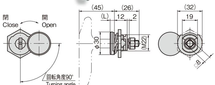
仕様 ● 材質: 本体/ステンレス鋼铸件 (SUS304)
