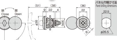
回転角度90° 製品質量(g) 価量販価格 Bulk Price 商品番号 Product No. Turning angle HS CAD Mass 耐火 Fire-resistance 5個~ ¥4,800 00786 ¥5,000 A-1220 2D/3D 165 No.0061-H 68 00182 ¥230 50個~ ¥221 No.0062-H 29 70142 ¥220 40個~ ¥211 ※大量のご注文は更にお安くなります。
