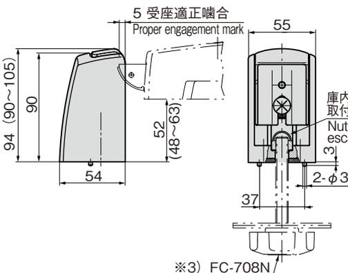
※3) 組込まれている六角ボルトをパネルの厚さに合わせて変更して下さい。
