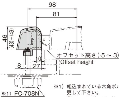
※1) 組込まれている六角ボルトをパネルの厚さに合わせて変更して下さい。
